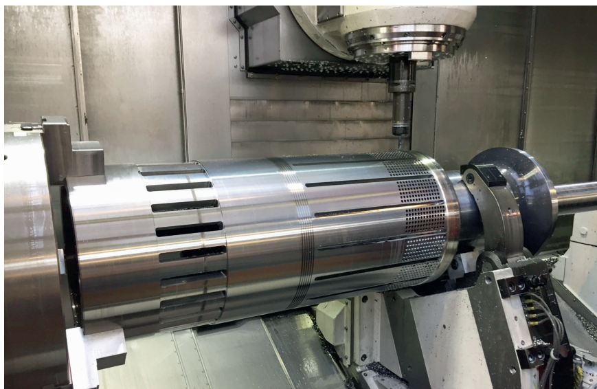
1 Auf der Komplettbearbeitungsmaschine Mazak Integrex e-500H II bearbeitet Pruss zahlreiche komplexe Großteile weitgehend in einer Aufspannung (© Mazak)
